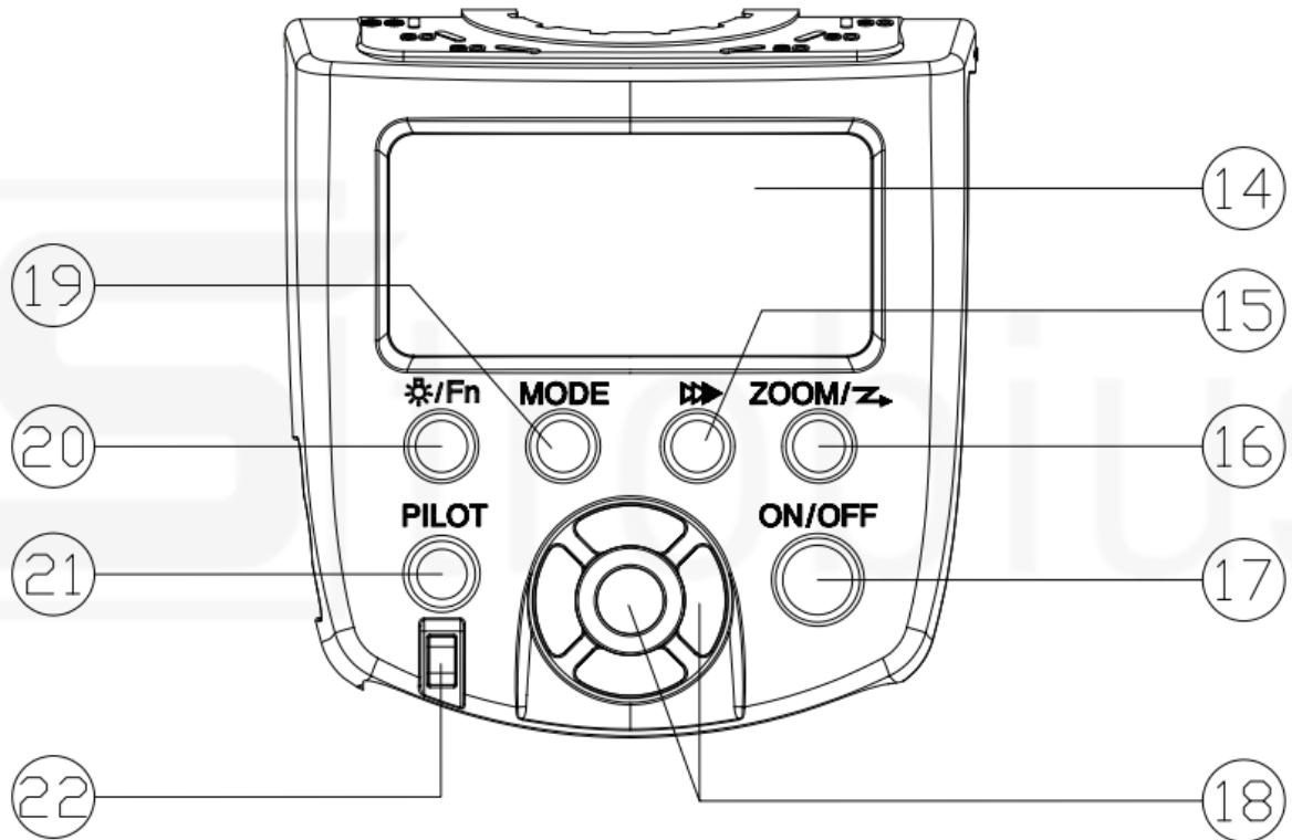
14. LCD дисплей: отображение статусов выбранных функций.
